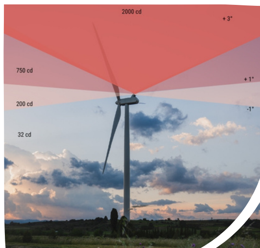
Schéma de l'intensité lumineuse : le feu s'adapte selon l'angle de site, passant de 2 000 candélas au-dessus de la nacelle à 32 candélas au niveau du sol, réduisant ainsi la visibilité nocturne depuis le terrain.
